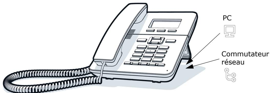
Ce type de raccordement vous permet d'économiser à chaque fois un point de raccordement au réseau sur le commutateur employé et d'utiliser des lignes plus courtes avec un agencement correspondant.
